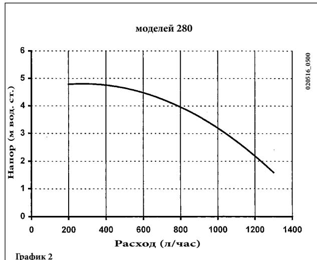
**ПРИМЕЧАНИЕ:** В модели 140-240 может быть установлен насос увеличенной мощности с характеристиками, аналогичными характеристикам насоса для модели 280.
