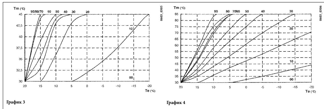
TM = температура воды на подаче в систему отопления
